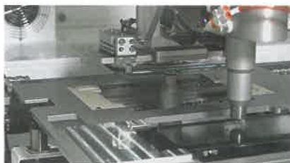
Bild 5: Optical Bonding: Dank der Plasmabehandlung verteilt sich der transparente Flüssigklebstoff perfekt auf der Glasoberfläche. Das garantiert eine luftblasenfreie Verklebung (Bild: Plasmatreat)
