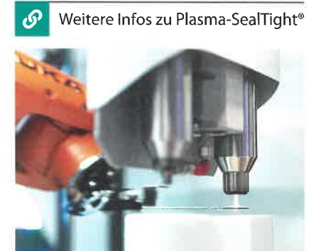
Bild 10: Vor dem Abschneiden der Plasma-SealTight®-Beschichtung wird die Edelstahloberfläche gereinigt (Bild: Plasmatreteat)
