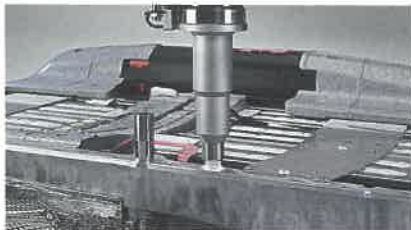
Bild 3: Die Reinigung mit Openair-Plasma® vor dem Abdichten des Batteriepacks gewährleistet eine deutliche Steigerung der Dichtwirkung
