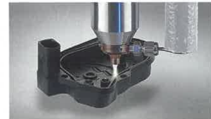
Bild 13: Zum Abdichten eines Kunststoffgehäuses wird eine PT-Bond-Beschichtung appliziert (Bild: Plasmatreat)
