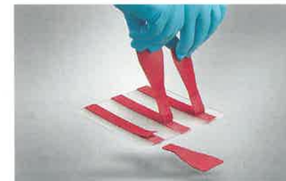
Bild 7: Durchgängiges kohäsives Versagen vermeiden: Durch den Einsatz des InMould-Plasma®-Verfahrens wird eine extrem haftungsstarke Verbindung zwischen verschiedenen polymeren Materialien hergestellt (Bild: Plasmatreat)
