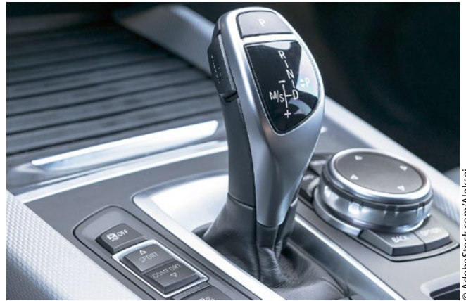
Eine Plasmabehandlung sorgt auch für langlebige Lackierungen und Beschriftungen auf den Bedienelementen im Fahrzeuginnenraum.
