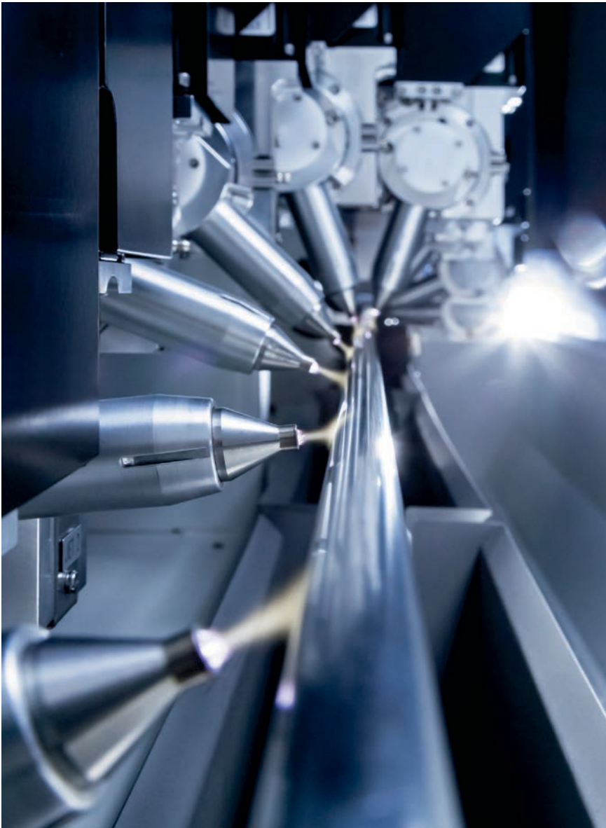
Bild 2 > Düsenkombination: Inline integrierte Plasmabehandlung im kontinuierlichen Extrusionsprozess von EPDM-Profilen
