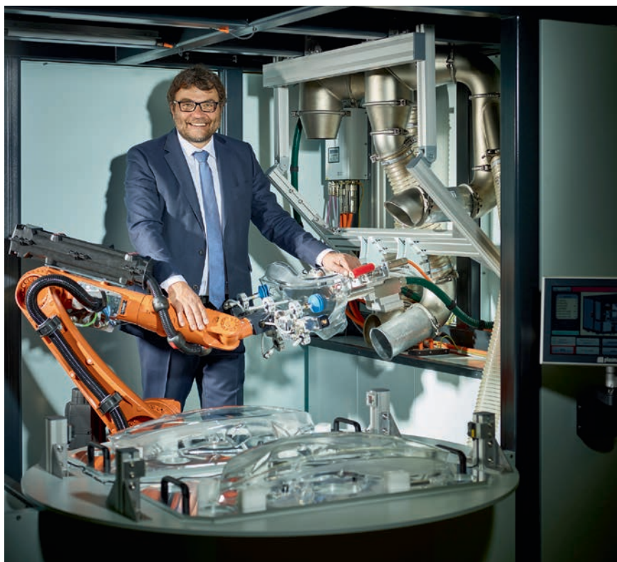
Bild 1 > Hightech in Westfalen: Plasmatreteat-Gründer Christian Buske in einer Plasmazelle der neuesten Generation zur Vorbehandlung der Kunststoff-Abdeckscheiben von PKW-Scheinwerfern
