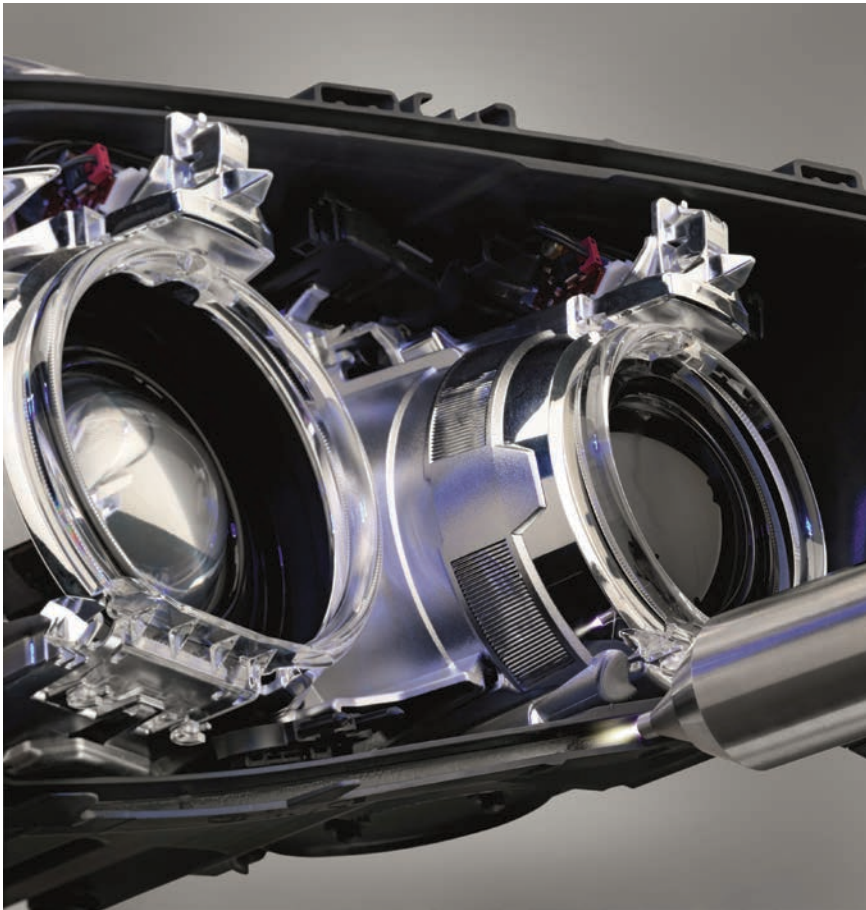
Bild 6 > Seit über 20 Jahren wird bei Hella die Openair-Plasmathechnik im Klebprozess der Polycarbonat-Linsen mit ihren Polypropylen-Gehäusen eingesetzt.
