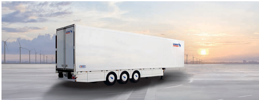
Bild 4 > Für die hohe Haltbarkeit und Dichtigkeit der Klebeverbindungen werden die Paneele des selbsttragenden Kühlkoffer-Systems im Bereich der Klebflächen umweltfreundlich mit Openair-Plasma vorbehandelt.
