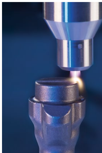
Bild 3 > Die Plasmavorbehandlung befreit Metalloberflächen von allen Verunreinigungen und organischen Kontaminationen.
