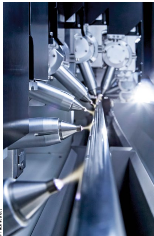
Bild 1 > Durch die Plasmabehandlung seiner EPDM-Profilabdichtungen vor der wasserbasierenden Lackierung konnte Hutchinson den Ausschuss auf ein Minimum senken.
