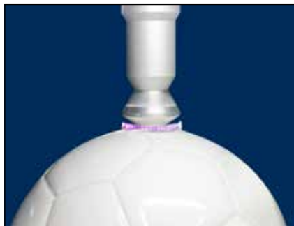
Openair-Plasma-Rotationsdüsen arbeiten mit Geschwindigkeiten von 2.700 Umdrehungen in der Minute. Das seitlich des violetten Lichtbogens ausströmende (nicht sichtbare) Plasma bewirkt eine hohe Aktivierung der Balloberfläche und in Folge ihre homogene Benetzbarkeit. (Bild: Heidelberger Druckmaschinen AG)
