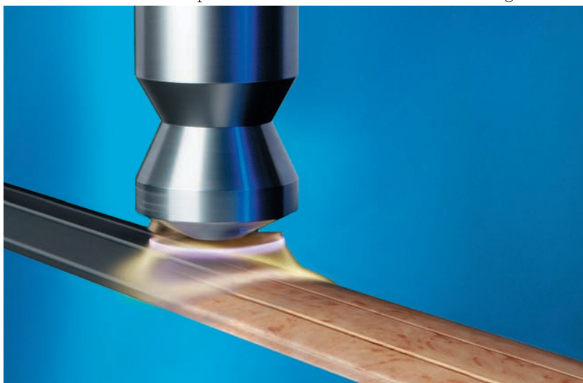
Bild 5: Ummantelung von Aluminiumleisten: Gegenüber Tauchbadverfahren kann die Vorbehandlung mithilfe der AD-Plasmadüsentechnik nicht nur weit schneller, sondern auch umweltfreundlich und kosteneffizienter erfolgen.
