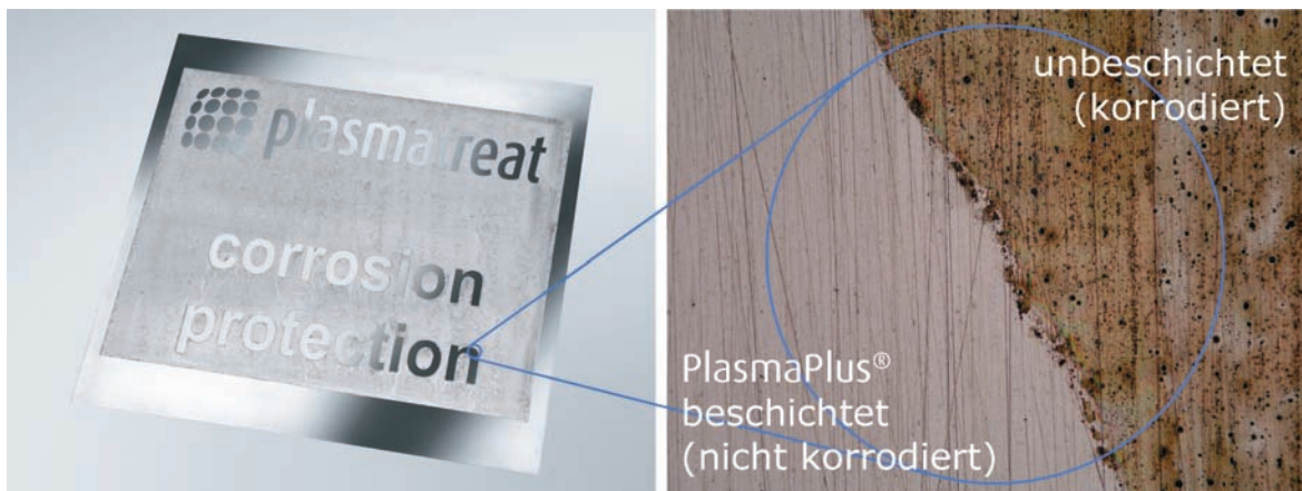
Bild 3: Die plasmapolymere Beschichtung bietet nicht nur einen exzellenten Haftgrund, sondern aufgrund ihrer guten Barrierewirkung gegen korrosive Elektrolyte gleichzeitig auch einen besonders hohen Korrosionsschutz.
