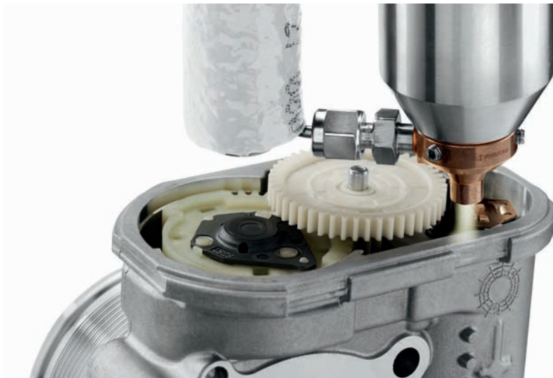
Bild 4: «PlasmaPlus»-Beschichtung eines Aluminium-Druckgussgehäuses vor dem Verkleben: Mit der Inline-Technik lassen sich produktspezifische multifunktionale Schichten generieren und sekundenschnell an genau definierter Stelle abscheiden.
