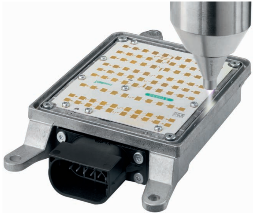
Bild 2: Der mit hoher Geschwindigkeit auf die Oberfläche auftreffende Plasmastrahl reinigt das Metall punktgenau von organischen Verunreinigungen und legt seine Oberflächenenergie wieder frei.
