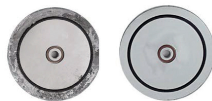
Abb. 4: Im Vergleich zwischen einem unbeschichteten (links) und einem im PlasmaPlus-Verfahren beschichteten Aluminium-Druckguss-Prüfkörper AlSi12(Fe) nach jeweils 720 Stunden Salzsprühtest zeigen sich die Vorteile der neu eingesetzten Technologie (Foto: Plasmatrete)
