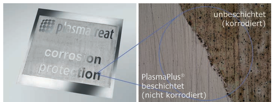
Abb. 3: Die plasmapolymere Beschichtung bietet nicht nur einen exzellenten Haftgrund, sondern aufgrund ihrer guten Barrierewirkung gegen korrosive Elektrolyte gleichzeitig auch einen besonders hohen Korrosionsschutz (Bild: Plasmareat)
