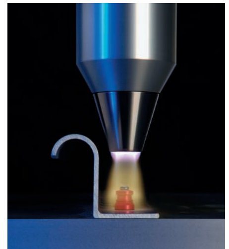
Abb. 6: Flugzeugbau: Die Kanten der kleinen Nieten sind anfällig für Beschädigungen und Korrosion; das berührungslos arbeitende Plasma ermöglicht die Vorbehandlung, ohne sie zu beschädigen (Bild: Plasmatreteat)
