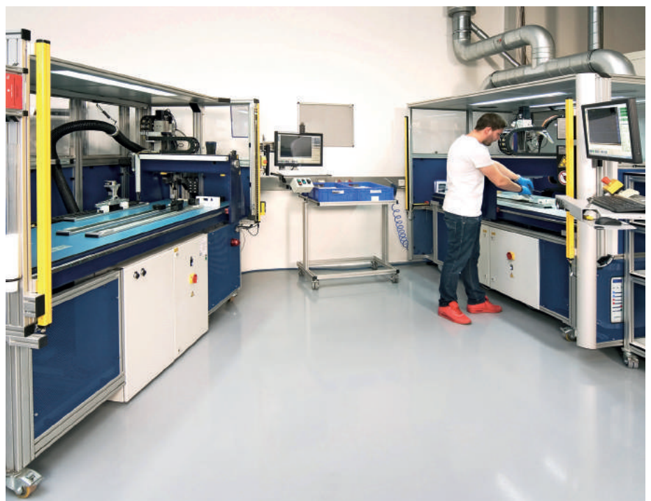
Abb. 6: Umweltfreundlich und wirtschaftlich: Plasmasystem (rechts) und Klebanlage (links) liegen sich direkt gegenüber. Die Gehäuseverklebung erfolgt unmittelbar im Anschluss an die Openair-Plasma®-Vorbehandlung (Bild: Plasmatreteat)
