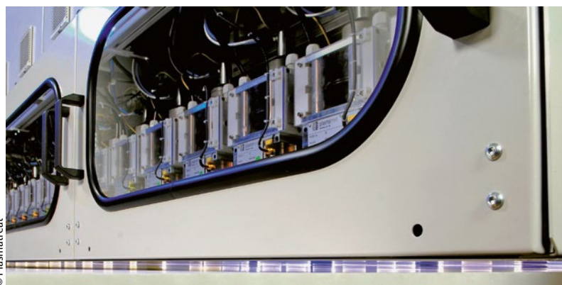
Bild 5 > 28 Openair-Plasma-Rotationsdüsen sorgen für die Feinstreinigung, statische Entladung und simultane Aktivierung der PP-Platten. Der Plasmaeffekt bewirkt die vollflächige Benetzbarkeit und deutliche Erhöhung der Haftungseigenschaften der Kunststoffoberfläche.
