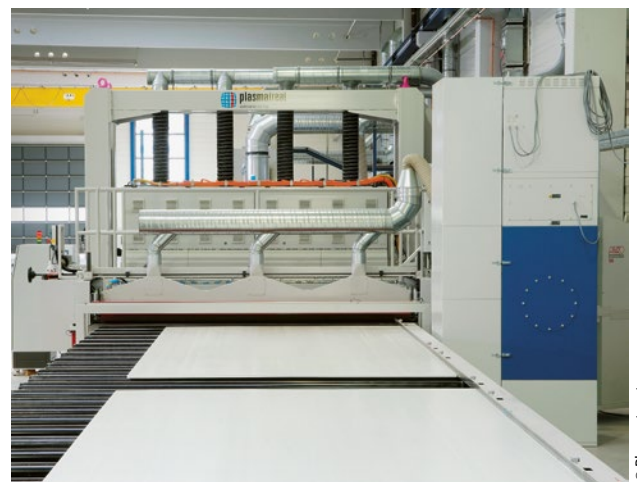
Bild 3 > Vor dem Grundieren und Lackieren werden bei MonoPan Composites die großen PP-Sandwichpaneele in nur 20 bis 40 sec vollautomatisch mit Atmosphärendruckplasma vorbehandelt.
