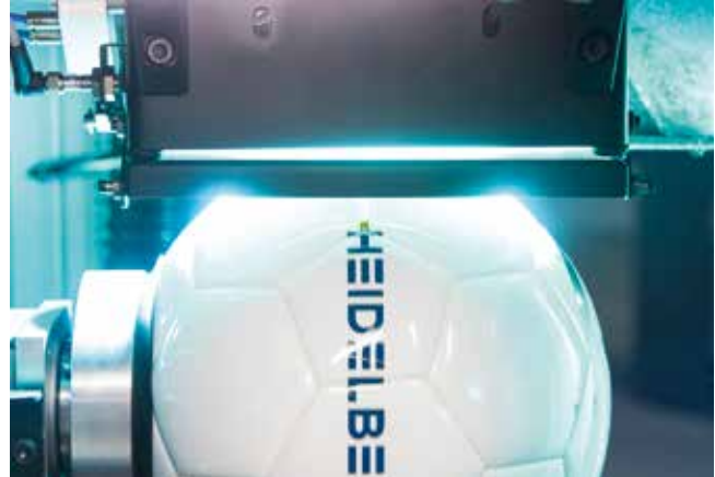
Bild 2. Vierfarbiger UV-Inkjet-Digitaldruck: Ein energiesparendes UV-LED-System sorgt für die sekundenschnelle Aushärtung der Tinten in der Omnifire (© Heidelberger Druckmaschinen)
