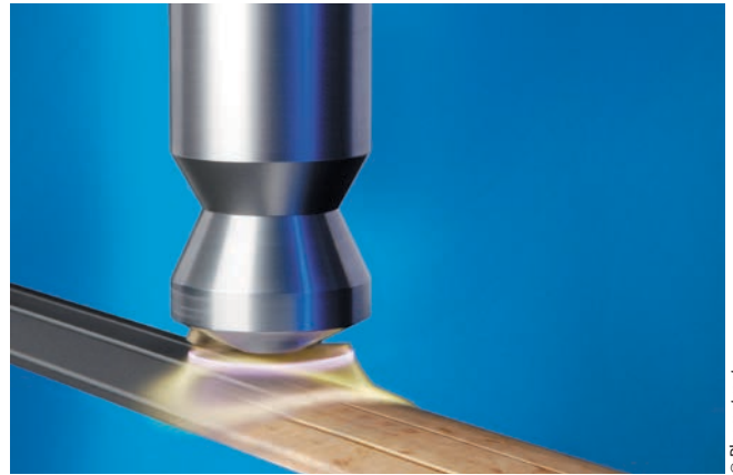
Bild 4 > Das Plasmaverfahren ermöglicht die chromfreie Vorbehandlung von Aluminiumprofilen. Bei Leisten für den Außenbereich wird zusätzlich eine Plasmapolymerisationsschicht aufgebracht.
