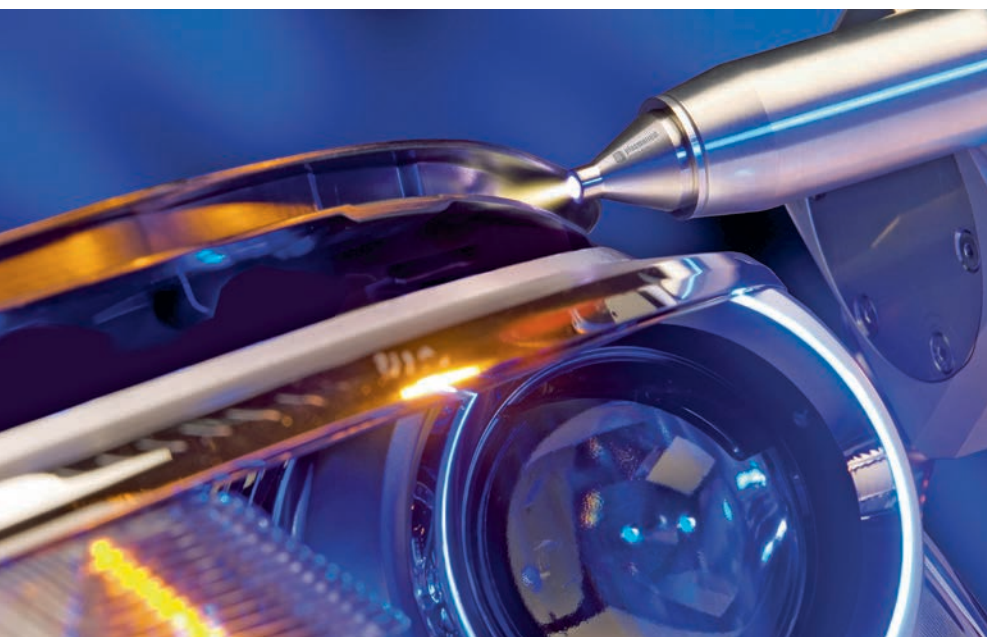
Bild 1 > Autoscheinwerfer müssen höchsten Dichtungsansprüchen genügen. Damit keine Feuchtigkeit in das Gehäuse eindringt, werden die Kunststoffnuten vor ihrer Verklebung mit Atmosphärendruckplasma gereinigt und aktiviert.
