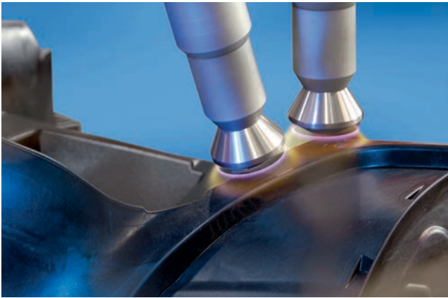
Bild 3 > Die robotergesteuerten Plasma-Rotationsdüsen arbeiten ortselektiv. Sie scannen konturgenau die Geometrie des Instrumententrägers und ermöglichen so den Verzicht auf eine Maskierung vor dem Schäumen.
