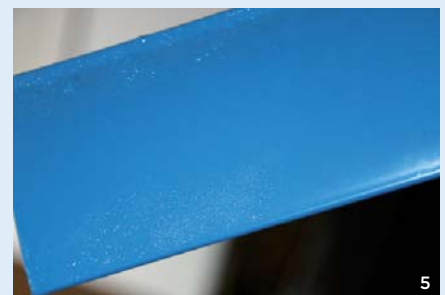
5 Die Benetzung nach Plasma-Aktivierung (Mitte) ist wesentlich besser als nach einer nasschemischen Behandlung.
