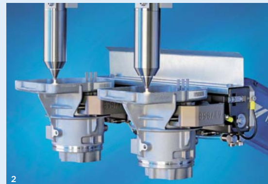
1 Funktionale Schichten aus der Plasmadüse: Plasmaplus ermöglicht einen hohen Korrosionsschutz auf Aluminium.
