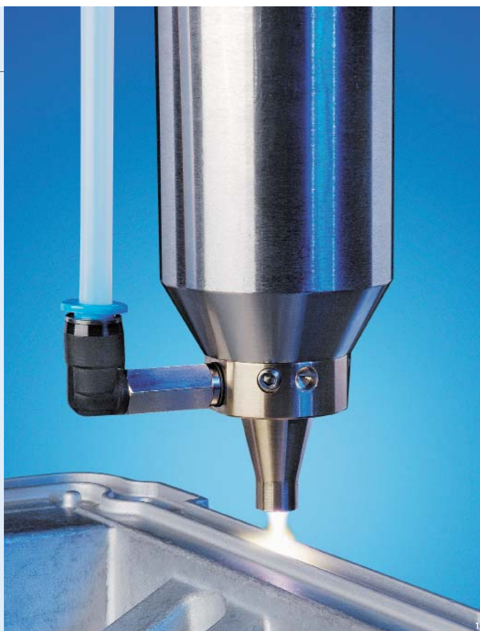
1 Funktionale Schichten aus der Plasmadüse: Plasmaplus ermöglicht einen hohen Korrosionsschutz auf Aluminium.
