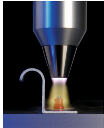
Die grundlegenden Parameter bei der Plasma-Vorbehandlung sind der Abstand der Düse zur Oberfläche sowie die Geschwindigkeit der Bestrahlung
