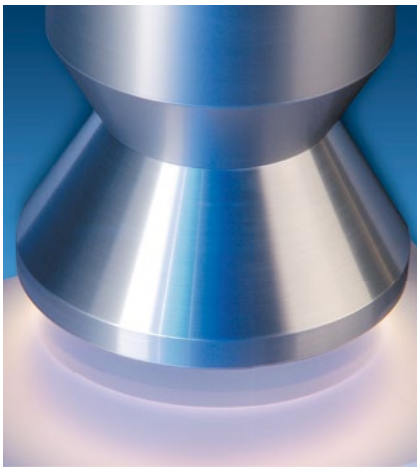
Rotationsdüse zur großflächigen Reinigung und Aktivierung. Der Plasmastrahl trifft mit hoher Geschwindigkeit auf die zu behandelnde Kunststoffoberfläche, deren Erwärmung dabei weniger als 30°C beträgt.
