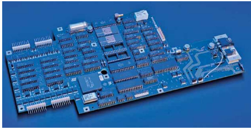
Abb. 5: Unter UV-Bestrahlung wird die Haftung des Lackes optisch geprüft, bevor die Baugruppe in das Funkgerät eingebaut wird und anschließend im Burn-in-Test ihre Stabilität unter Beweis stellen muss Bild: Plasmatreteat
