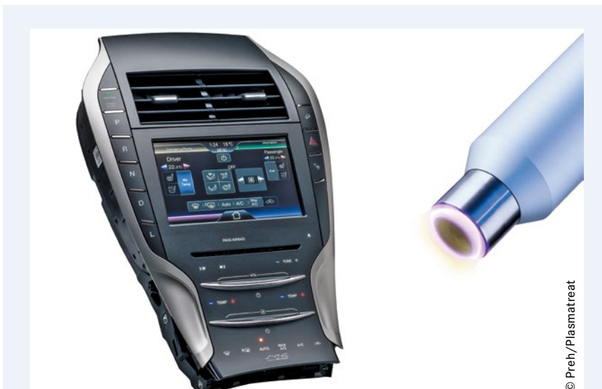
Bild 1: Die Verklebung der PET-Touchfolie auf dem neuen 3D-Bedienfeld des Ford Lincoln MKZ versagte im Klimatest. Durch Einsatz von Atmosphärendruckplasma konnte dieses Problem schließlich gelöst werden.
