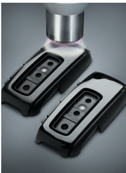
Das linke Bauteil zeigt die Vorbehandlung der PA-Schlüsselunterschale mit Openair-Plasma. Rechts dasselbe Teil nach Auftrag der transparenten Kratzfestbeschichtung (Bilder: Plasmatreut)
