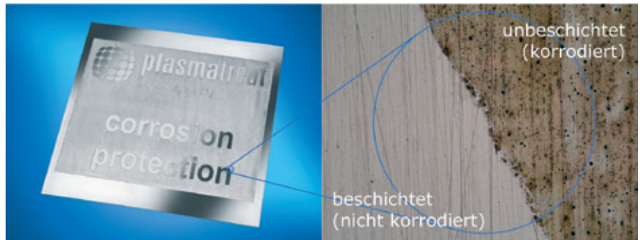
! Abb. 3: Die mikroskopische Aufnahme zeigt: Der mit der PlasmaPlus Schicht geschützte Bereich zeigt auch nach Einwirkung von 96h Salzsprühetest keine Anzeichen von Korrosion. Bild: Plasmatreat
