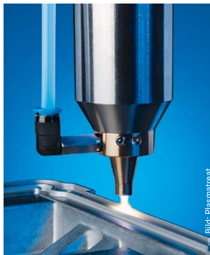
Bild 1: Was bisher nur in der Vakuumkammer gelang, ist jetzt inline unter normalen Luftbedingungen möglich: die funktionale Beschichtung von Aluminiumbauteilen.
