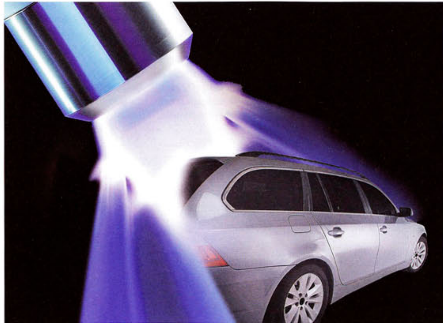
Bei Umlackierungen von Karosserien ersetzt die Openair-Plasmabehandlung des fehlerhaften Decklacks nicht nur den kompletten Schleifprozess, sondern führt auch zu besseren Haftungsergebnissen.
