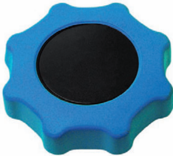
Bild 4: Bei diesem Verstellrad wird erst durch die Plasmavorbehandlung der feste Verbund eines harten Polypropylens (innen) und einer weichen, griffigen TPU-Spritzguss-Ummantelung möglich.
