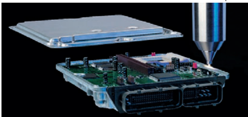
Bild 5: Für ein festes Verkleben der beiden Aluminium-Gehäusehälften sorgt eine Vorbehandlung mit Atmosphärendruckplasma.
