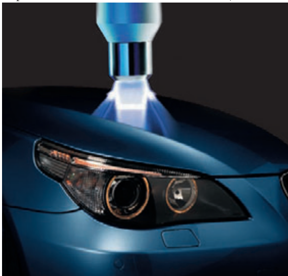
Bild 1: Die Plasmatechnologie «Openair» schafft damit die entscheidenden Voraussetzungen für den Erfolg nachfolgender Kleb- und Lackierungsprozesse.
