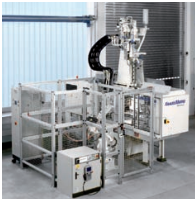
Die Fertigungszelle für die Inline-Plasmavorbehandlung steht im Technikum bei Neue Materialien Fürth.
