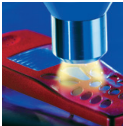
Vorbehandlung eines Handygehäuses mit einer rotierenden Plasmadüse. Photo: Plasmatreat
