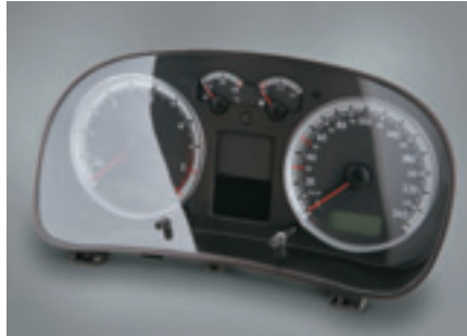
Nach dem Spritzgießen, aber vor dem Lackieren von Cockpitmodulgehäusen erfolgt zunächst die porentiefe Reinigung mit Plasma. Photo: Plasmatreat
