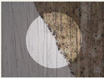
Unter dem Mikroskop: Der mit der Plasma-Schicht geschützte Bereich zeigt auch nach Einwirkung von 96 Stunden direktem Salzsprühetest keine Anzeichen von Korrosion
