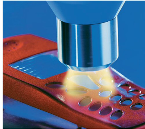
Abb. 6: Die Vorbehandlung mit Openair -Plasma sorgt für die mikrofeine Reinigung des Handygehäuses vor dem Lackieren
