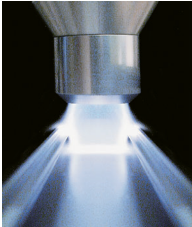
Abb. 3: Der elektrisch neutrale Plasmastrahl ermöglicht die mikrofeine Reinigung, hohe Aktivierung und hauchdünne Beschichtung von Oberflächen
