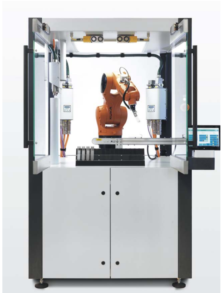
Bild 6: Die schlüsselfertige, vollautomatische Plasmazelle PTU1212 beinhaltet alles, was der Plasmaprozess verlangt und kann an jede handelsübliche Spritzgiessmaschine angeschlossen werden.
