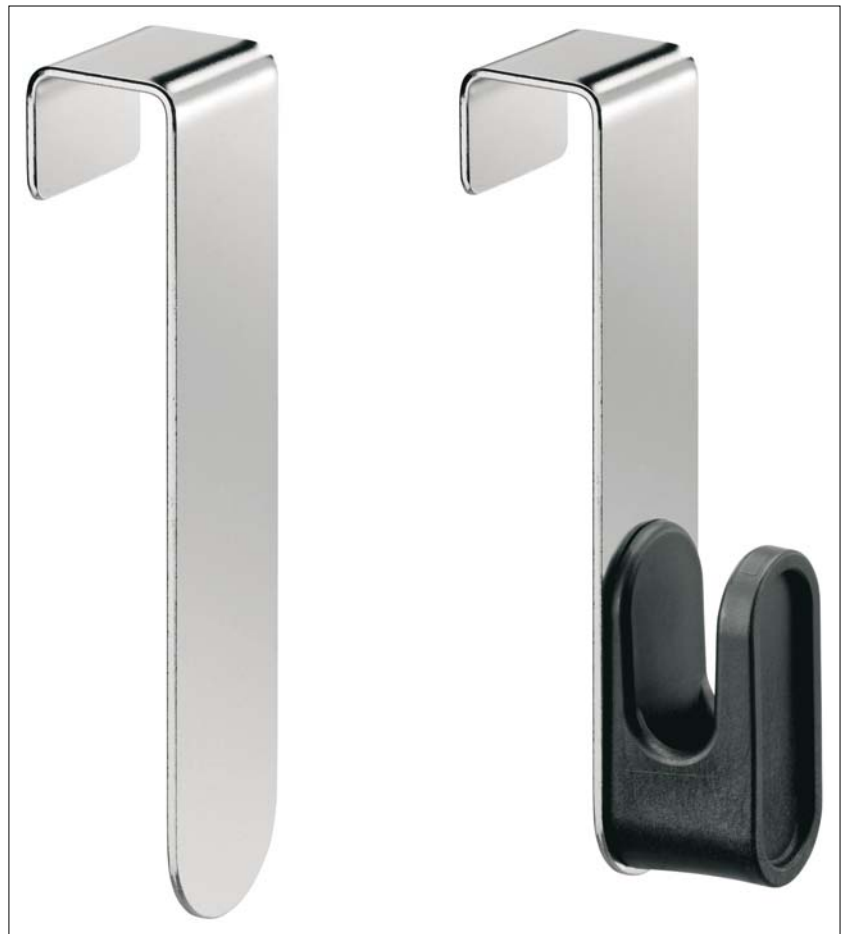
Bild 2: Der Metallkörper (links) kann sofort nach der Beschichtung im Atmosphärendruckplasma mit dem Thermoplast-Compound (rechts) überspritzt und zum festen Verbund gebracht werden.
