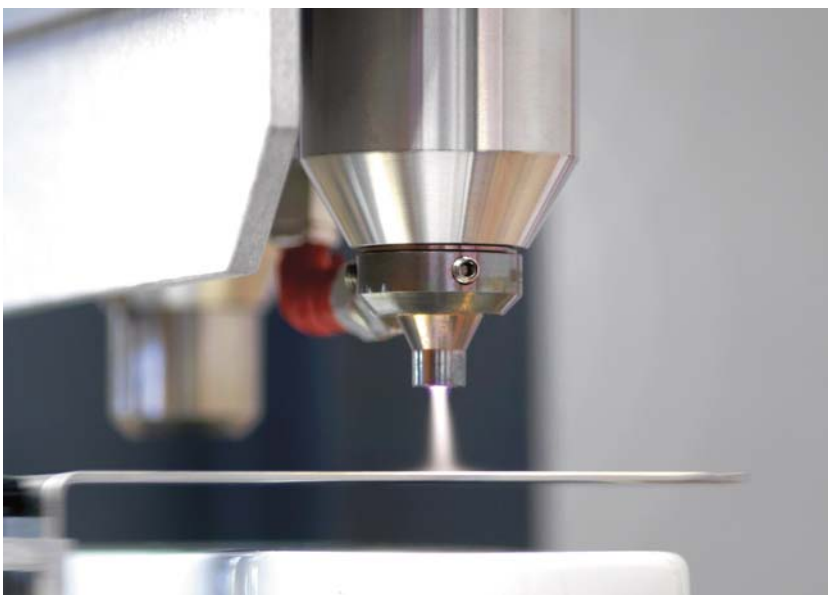
Bild 1: Mit dem chemisch-physikalischen «Plasma-SealTight»-Verfahren lassen sich in Millisekunden funktionelle Nanoschichten ortsselektiv abscheiden und in Folge stoffschlüssige Verbindungen unterschiedlicher Materialien erzeugen. (Bilder: Plasmatreat GmbH)
