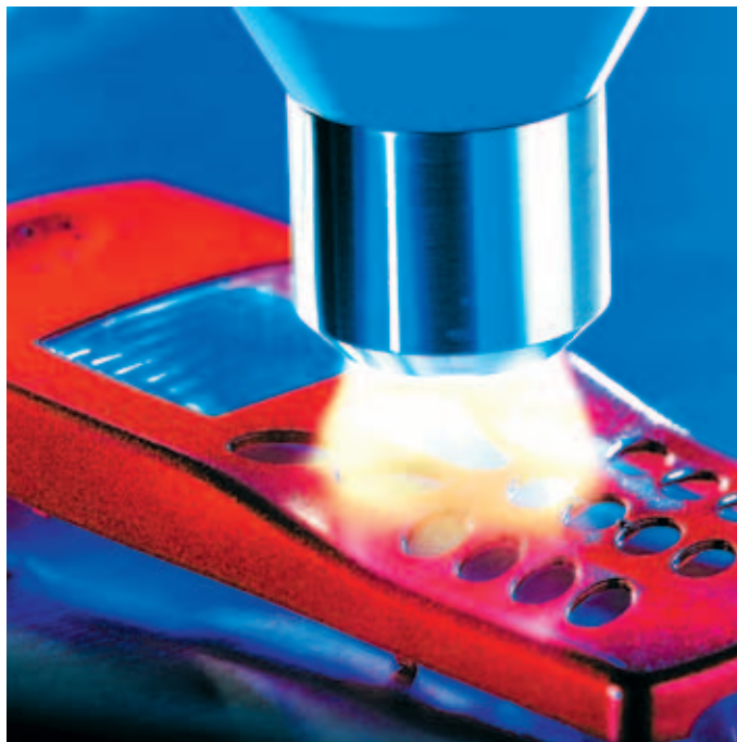
Die atmosphärische Plasmatechnologie ermöglicht auf umweltfreundliche Weise die mikrofeine Reinigung, Aktivierung und Nanobeschichtung von Materialoberflächen für Nachfolgeprozesse wie das Lackieren, Bedrucken, Verkleben und Beschichten
