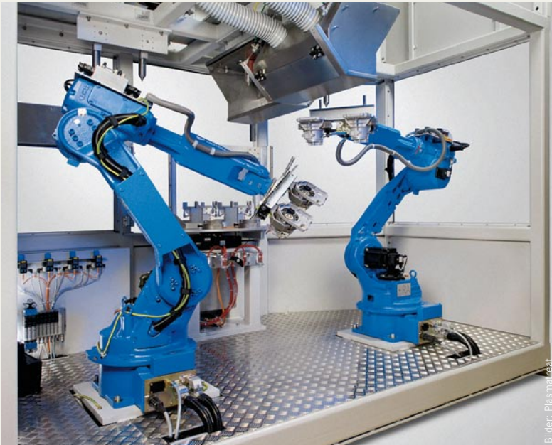
Roboteranlage zur Plasma-Beschichtung von Motor-Pumpengehäusen für die Automobilindustrie
