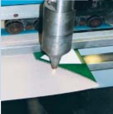
Automatikbodenschachteln: Vorbehandlung mit Openair- Plasma von oben.
