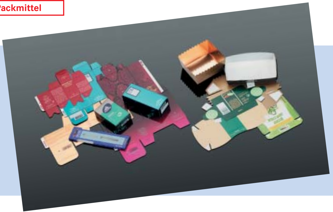
Ob Längsnaht - oder Aufrichtezuschnitt: Wichtig für die Faltschachtel ist die Klebhaftung.
