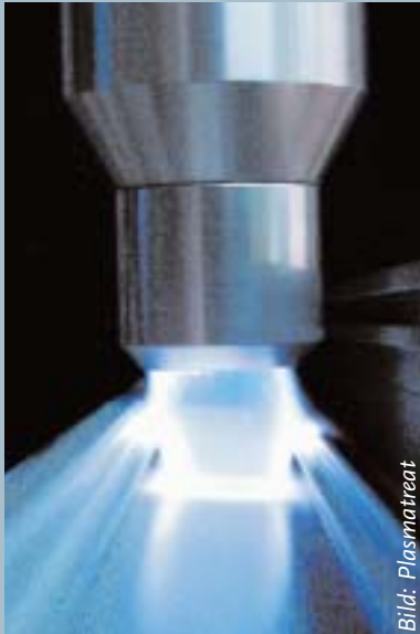
Bild 2: Das austretende Plasma steht je nach Düsengeometrie in einem Arbeitsbereich bis 25 mm Wirkbreite oder 40 mm Behandlungsabstand wirksam zur Verfügung
