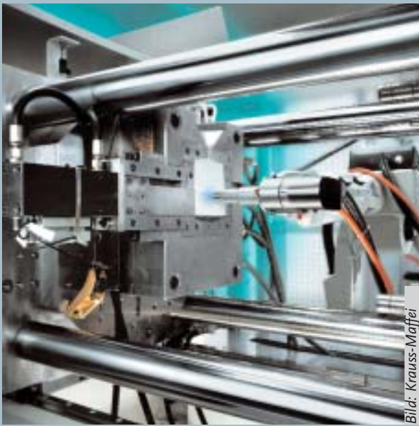
Bild 5: In der 2-Komponenten Spritzgussmaschine wird der Grundträger für den Automobil-Innenraum spritzgegossen und nach einer Openair-Plasmabehandlung sofort mit einer Weichkomponente überspritzt
