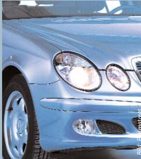
Bild 4: Im Karosseriebau werden einzelne Baugruppen heute nicht mehr aus Stahl- oder Aluminiumblechen, sondern aus Hochleistungskunststoffen gefertigt. Die sichere Haftung eines 2-Komponenten-Polyurethan Klebstoffes auf SMC bzw. PPO (z.B. Noryl) wird durch die Vorbehandlung mit Plasma erzielt.
